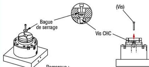
Remarque : Placez la bague de serrage au-dessus de la vis de fixation de la pince de serrage.
