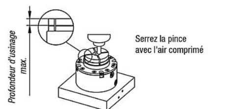
Serrez la pince avec l'air comprimé
