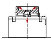
En injectant l'air comprimé, la pince de serrage est tirée vers le bas. Les 4 segments de serrage se déplacent vers l'intérieur, permettant ainsi le serrage de la pièce.
