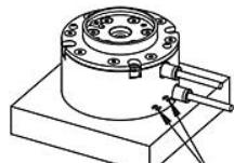
Vérifiez l'étanchéité des raccords inférieurs.
